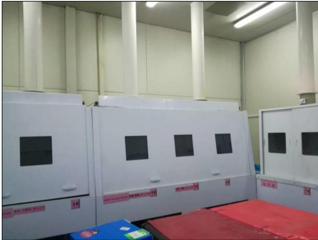
图4.3-4化学清洗设备样式（内置清洗槽）
