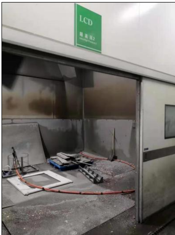
图2.2-17超高压冲洗间样式
